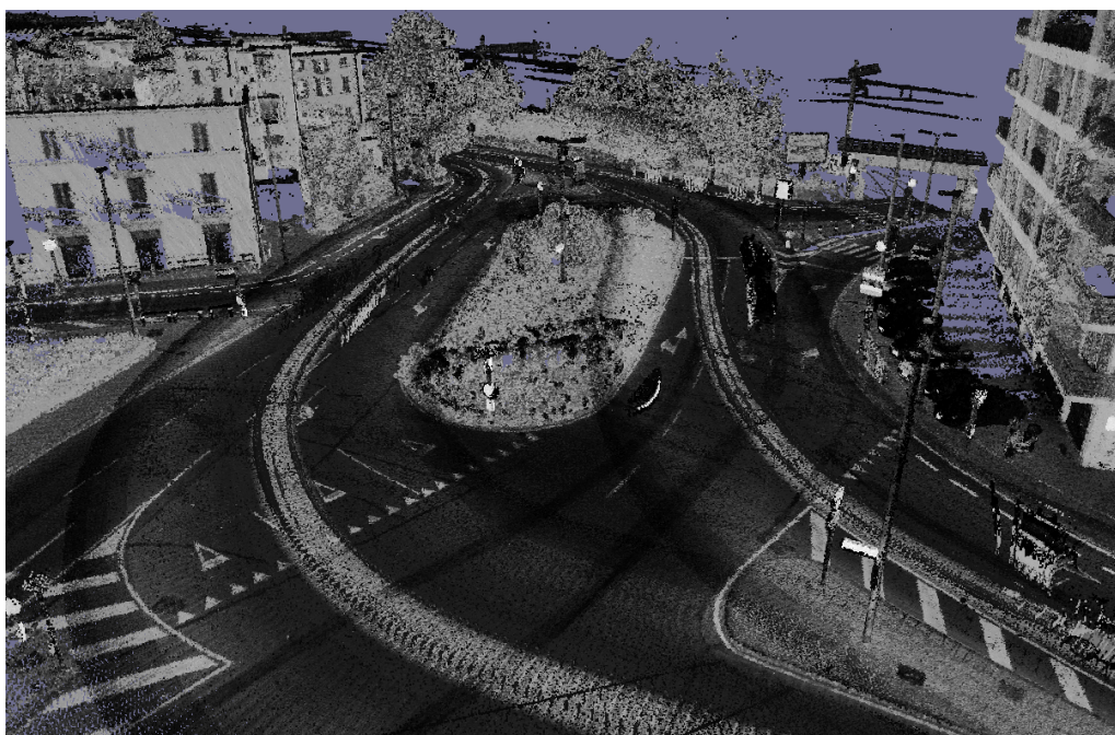
Figura 6 - Immagine nuvola di punti Leica Pegasus Backpack
